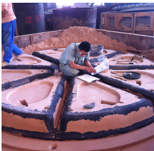
De laatste inspectie van de mal
