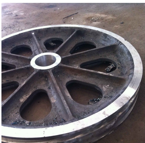
Het kabel wiel wordt nabewerkt
